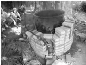
写真4-10 耐火モルタルの焼成
